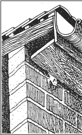
Abb. 27: Einflug über Spalten am Dachkasten<sup>7</sup>
