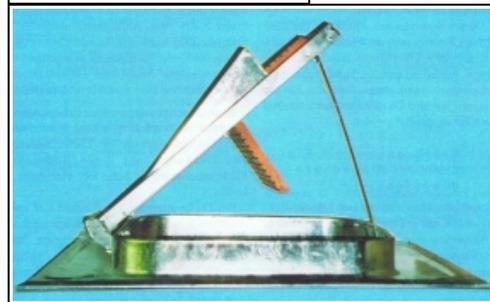
Abb. 18: Fledermaus-Dachfenster Modell BODO STRATMANN - Mit Anflugbrettchen innen und außen, Fledermausdurchgang unabhängig von geöffnetem oder geschlossenem Fenster<sup>16</sup>
